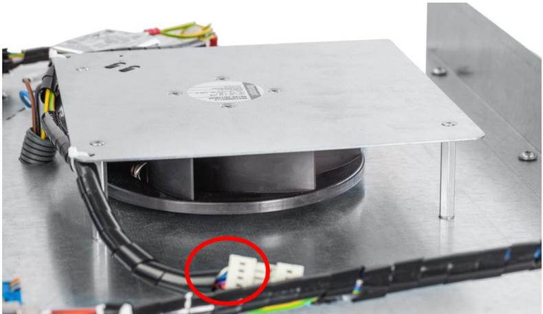
Figura 31: distacco del ventilatore
