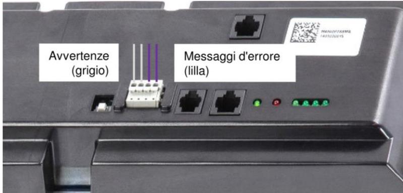
Figura 20: collegamenti a morsetto per messaggi d'errore e avvertenze
