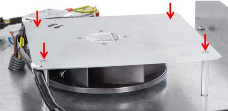
Figura 32: smontaggio del ventilatore
