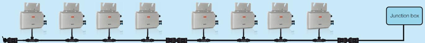
Piccolo impianto, più di quattro MICRO AC TRUNK BUS, due kit accessori di montaggio\* e un kit accessori di estensione
