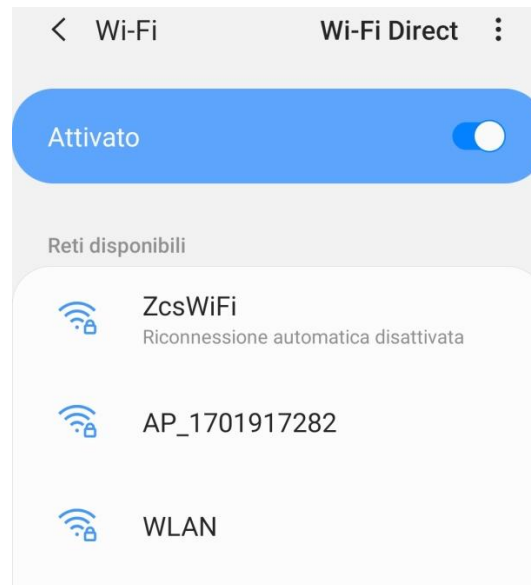
Figura 46 - Disattivazione della riconnessione automatica ad una rete
