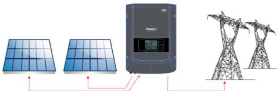
Figura 2 - Impianto fotovoltaico connesso in rete
