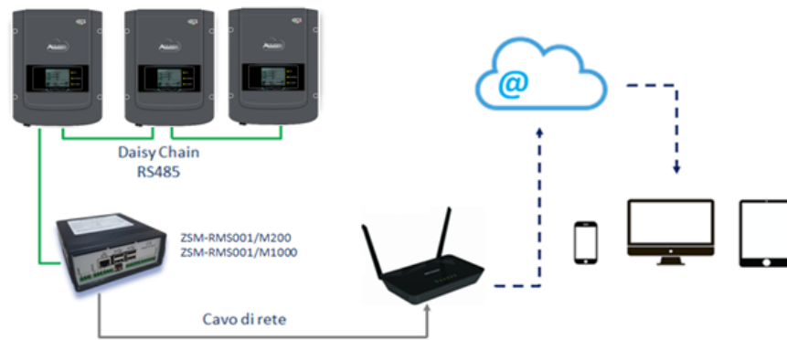
Figura 62 – Schema di funzionamento del datalogger ZSM-RMS001/M200 / ZSM-RMS001/M1000
