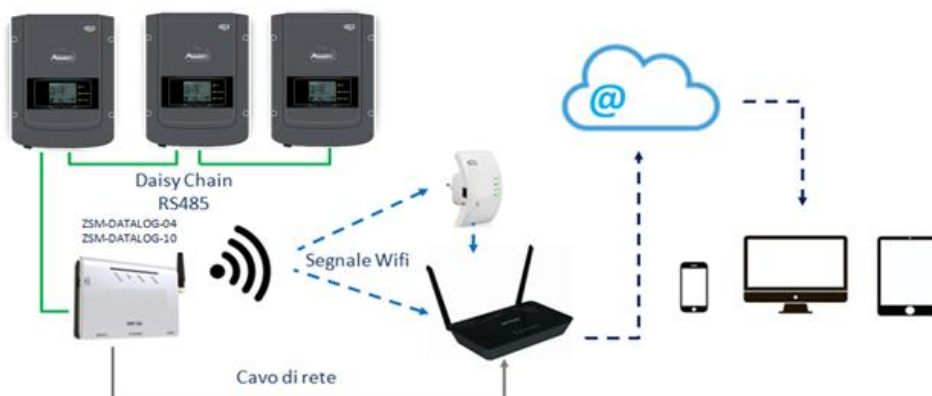
Figura 61 – Schema di connessione del datalogger ZSM-DATALOG-04 / ZSM-DATALOG-10
