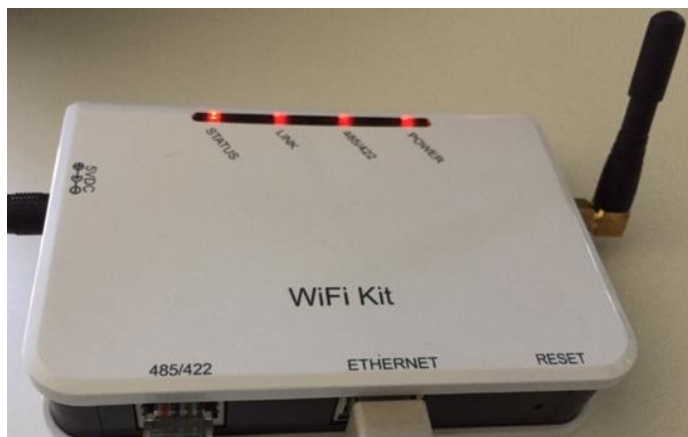
Figura 82 – Led che indicano la corretta configurazione del datalogger
