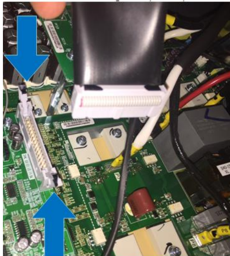
Figura 42 - Apertura dei ganci presenti sull'alloggiamento del connettore flat
