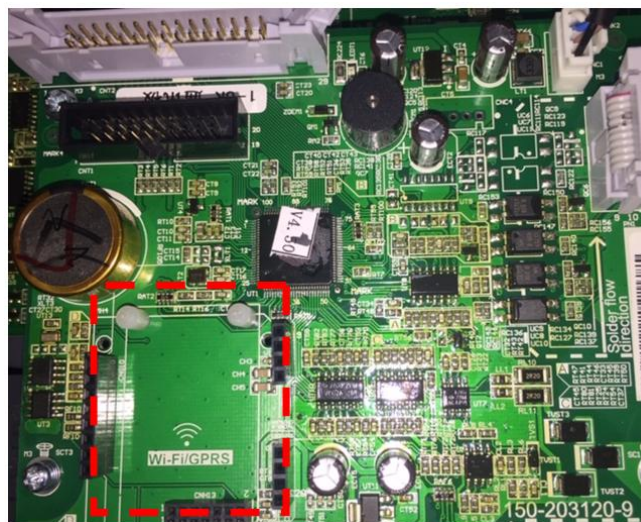
Figura 43 - Posizione di alloggiamento della scheda wifi sulla scheda di comunicazione
