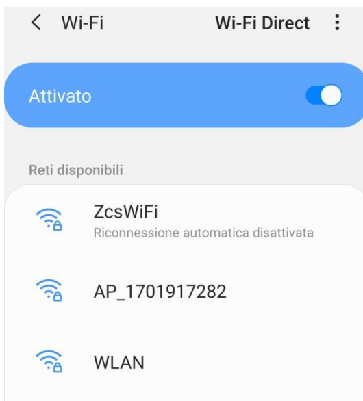
Figura 103 - Disabilitazione della riconnessione automatica a una rete
