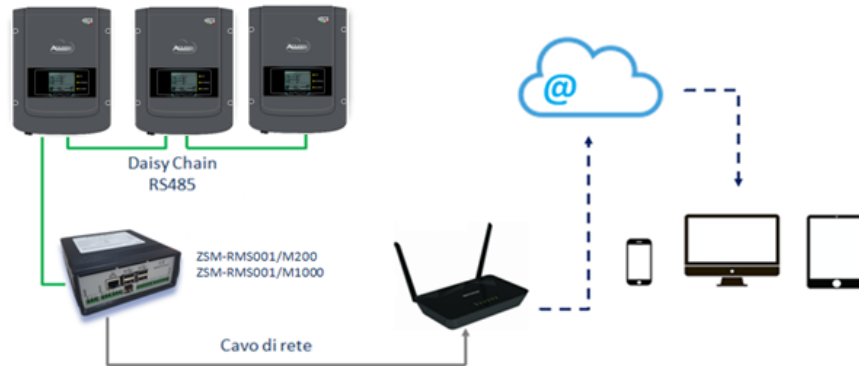
Figura 94 – Schema che mostra il funzionamento del datalogger ZSM-RMS001/M200 / ZSM-RMS001/M1000
