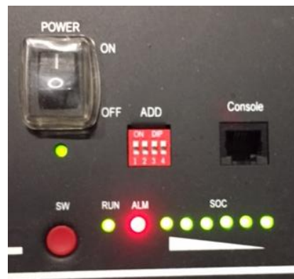
Figura 50 - Stato della batteria dopo aver impostato l'interruttore POWER su ON e aver premuto il pulsante SW
