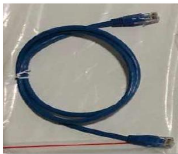
Figura 37 – Cavo di comunicazione tra batterie AZZURRO 5000
