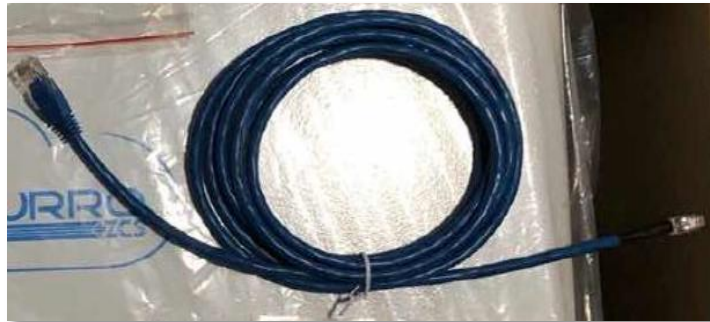
Figura 26 - Cavo di comunicazione tra l'inverter e la batteria WeCo 5k3
