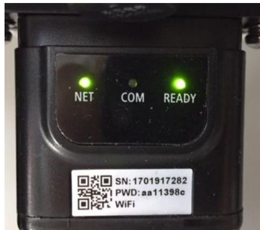
Figura 72 - Stato di comunicazione irregolare tra inverter e adattatore
