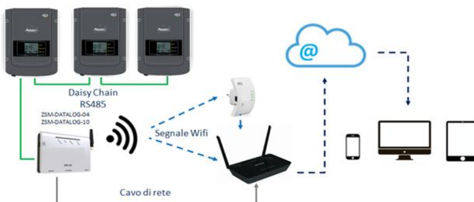
Figura 80 – Schema per il collegamento del datalogger ZSM-DATALOG-04 / ZSM-DATALOG-10
