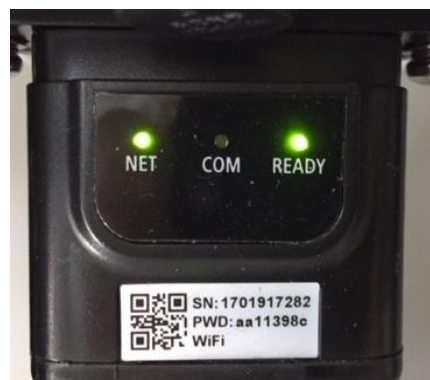
Figura 78 - Stato di comunicazione irregolare tra inverter e adattatore
