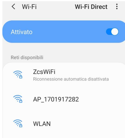
Figura 45 - Disabilitazione della riconnessione automatica a una rete
