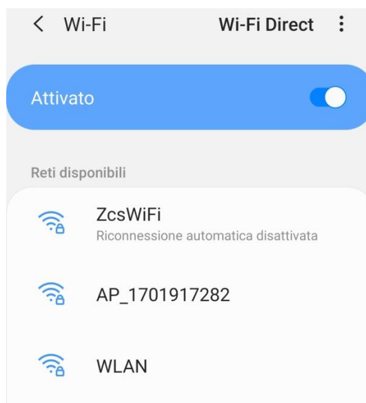
Figura 90 - Disabilitazione della riconnessione automatica a una rete
