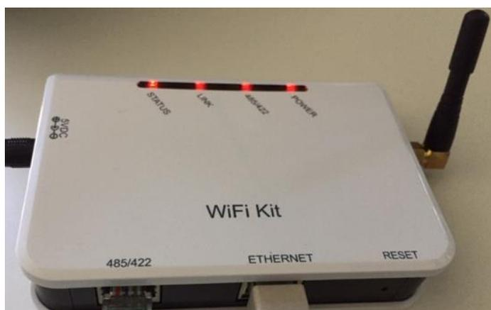
Figura 98 – Led che indicano la corretta configurazione del datalogger
