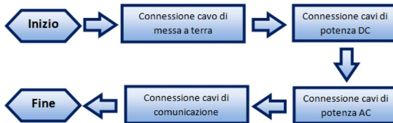
Figura 17 - Passaggi per la connessione dei cavi
