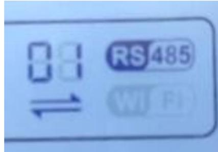
Figura 84 – Simbolo RS485 sul display dell’inverter
