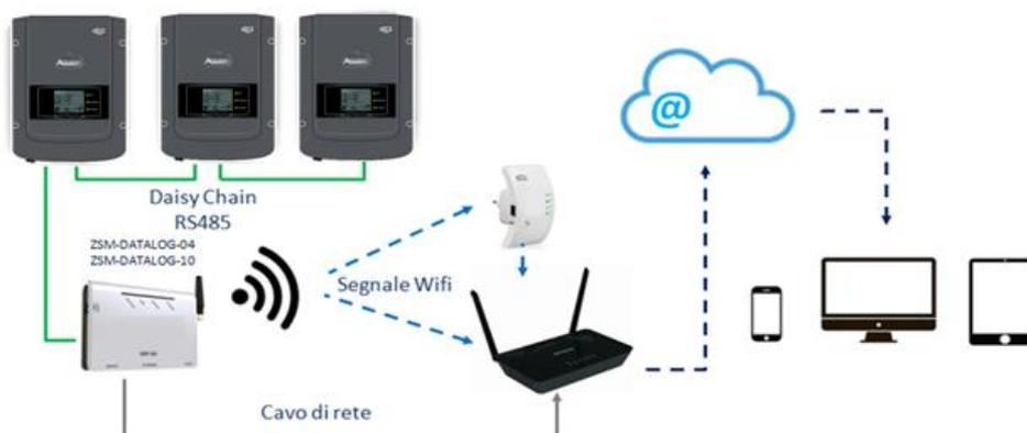
Figura 77 - Schema di connessione del datalogger ZSM-DATALOG-04 / ZSM-DATALOG-10
