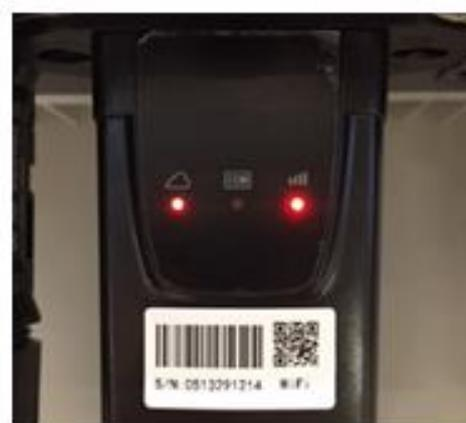
Figura 58 - Stato di comunicazione irregolare tra inverter e wifi
