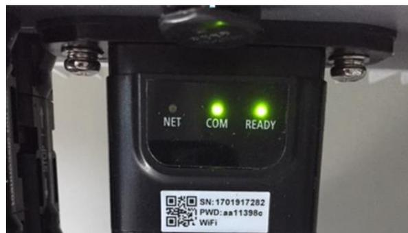
Figura 73 – Stato iniziale dei led
