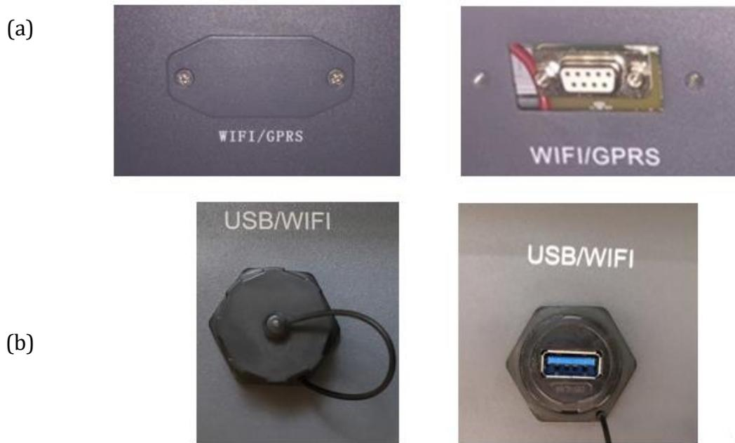
Figura 71 - Alloggiamento della scheda 4G
