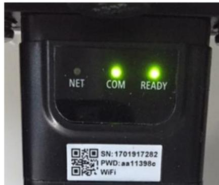
Figura 76 – Stato di comunicazione irregolare tra scheda e server remoto
