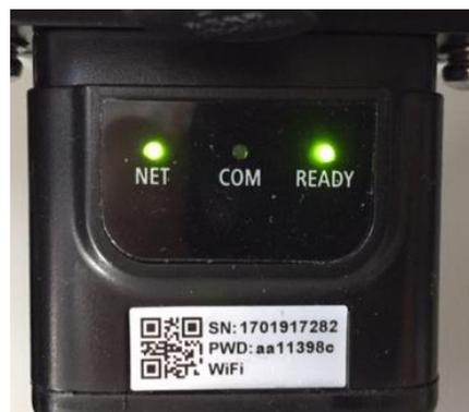
Figura 75 - Stato di comunicazione irregolare tra inverter e scheda
