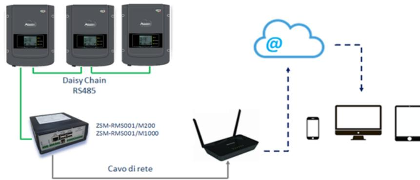
Figura 78 – Schema di funzionamento del datalogger ZSM-RMS001/M200 / ZSM-RMS001/M1000
