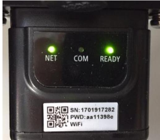
Figura 69 - Stato di comunicazione irregolare tra inverter e scheda
