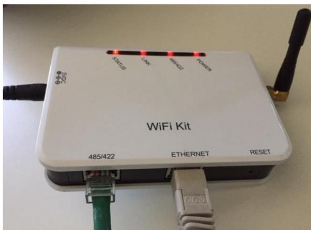
Figura 85 – Cavo ethernet connesso al datalogger
