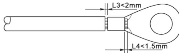
Figura 14 - Preparazione del cavo di terra (2)
