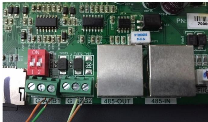
Figura 80 - Collegamento linea seriale tramite morsettiere RS485 e tramite plug RJ45
