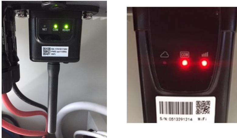
Figura 54 – Stato iniziale dei led
