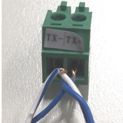
Figura 79 - Serraggio del cavo di rete sul morsetto RS485
