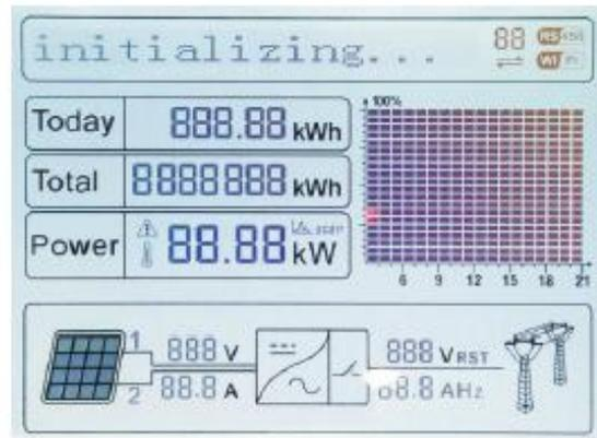
Figura 33 - Interfaccia principale del display LCD
