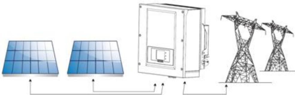
Figura 2 - Impianto fotovoltaico connesso in rete
