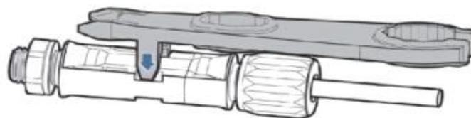
Figura 20- Rimozione del connettore DC
