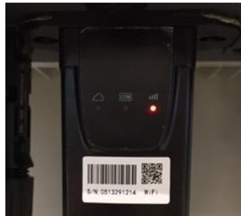
Figura 59 – Stato di comunicazione irregolare tra wifi e server remoto
