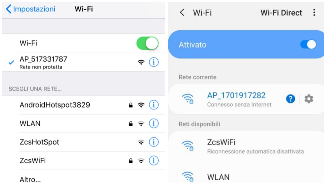
Figura 41 – Connessione all'Access Point della scheda wifi su Smartphone iOS (a sinistra) e Android (a destra)
