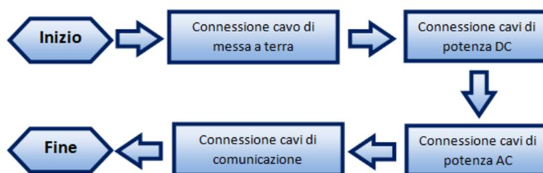
Figura 11 – Passaggi per la connessione dei cavi
