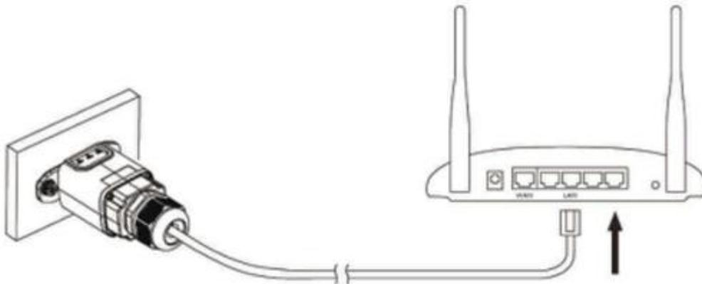
Figura 65 – Collegamento del cavo di rete al modem
