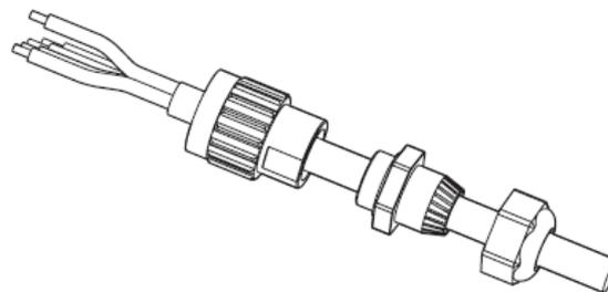
Figura 23 - Connessione dei cavi AC di uscita (2)
