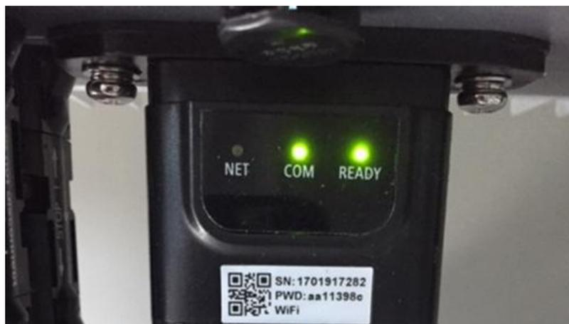
Figura 66 – Stato iniziale dei led
