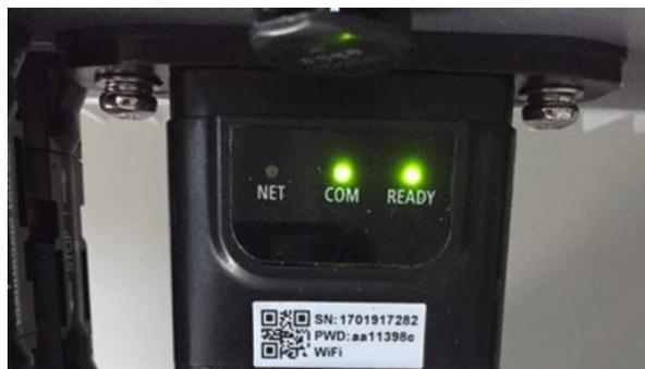
Figura 72 - Stato iniziale dei led
