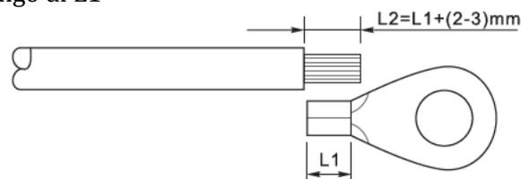
Figura 13 - Preparazione del cavo di terra (1)
