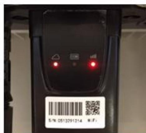
Figura 57 - Stato di comunicazione irregolare tra inverter e wifi
