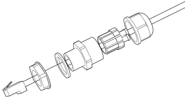
Figura 28 - Montaggio del connettore di comunicazione
