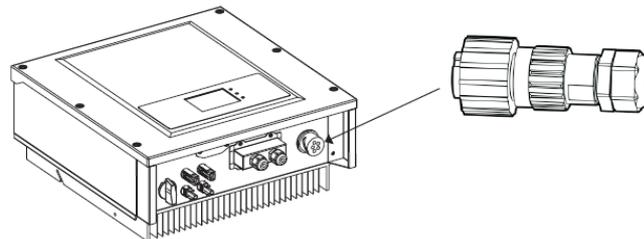
**Figura 25 - Connessione dei cavi AC di uscita (4)**
