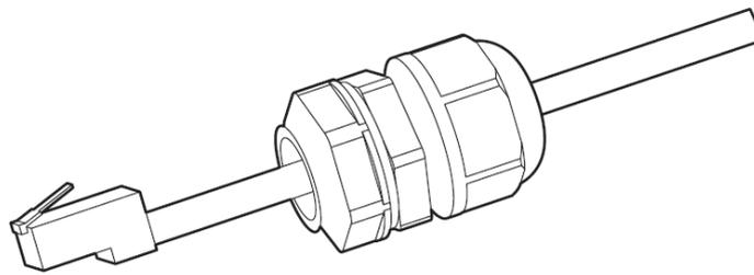
Figura 29 - Montaggio del connettore di comunicazione
