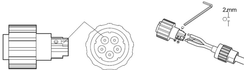
**Figura 24 - Connessione dei cavi AC di uscita (3)**
