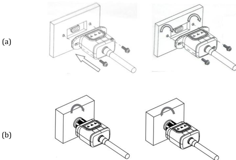
Figura 38 - Inserimento e fissaggio della scheda wifi esterna
