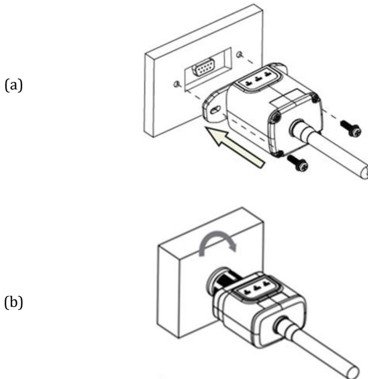
**Figura 71 - Inserimento e fissaggio della scheda 4G**
