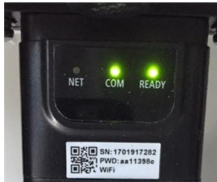
Figura 75 – Stato di comunicazione irregolare tra scheda e server remoto
