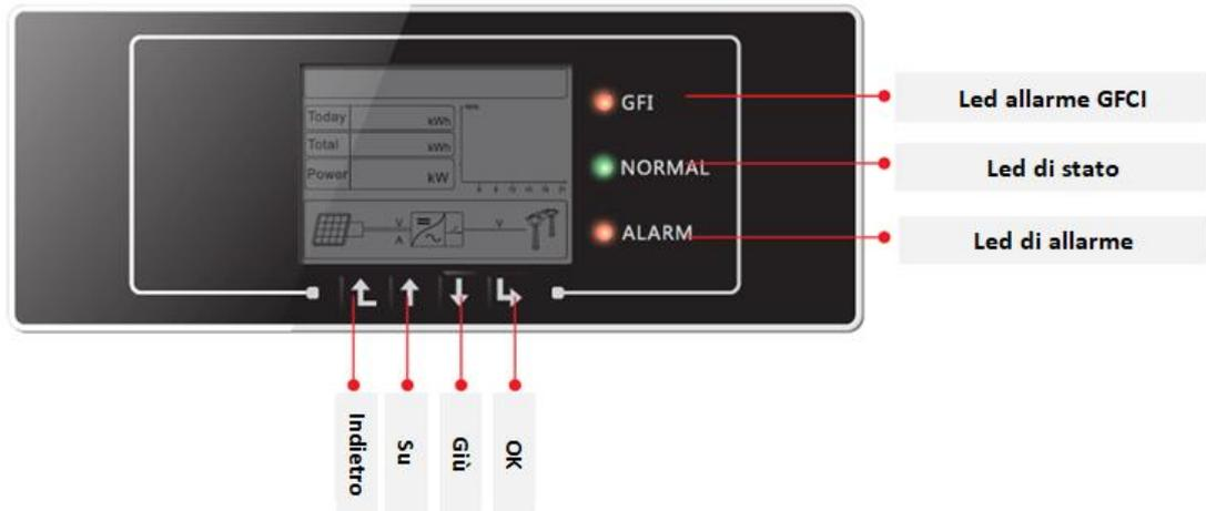
Figura 32 - Display LCD con pulsanti e indicatori led
