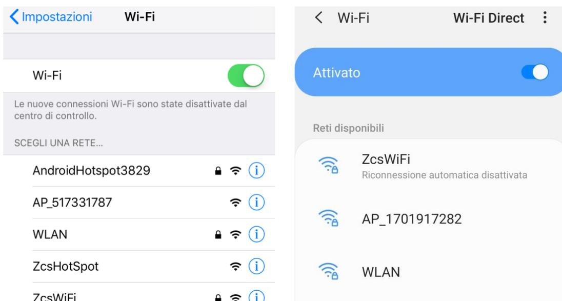
Figura 85 - Ricerca delle reti wifi su Smartphone iOS (a sinistra) e Android (a destra)
