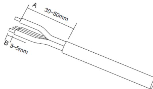
Figura 22 - Connessione dei cavi AC di uscita (1)
