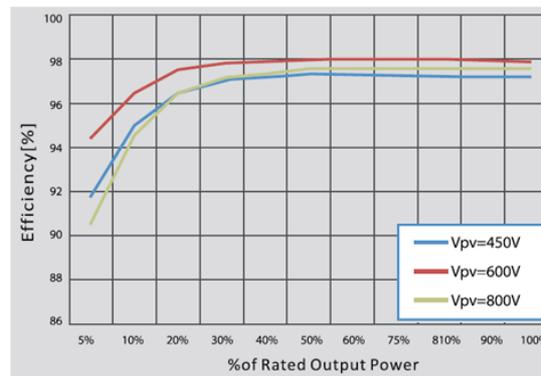
Figura 6 – Curva di efficienza per un inverter Azzurro ZCS 11K TL-V1
