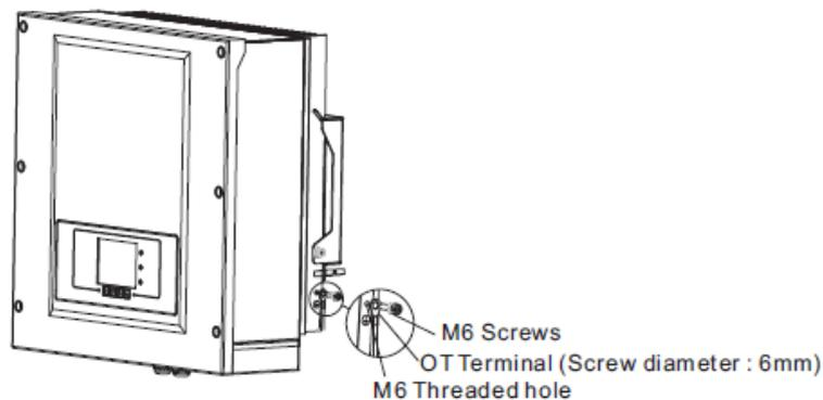
Figura 12 - Collegamento del terminale di terra
