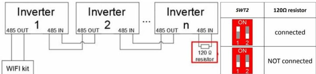
Figura 82 – Posizione dei dip switch per collegare la resistenza di isolamento
