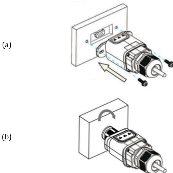
Figura 64 – Inserimento e fissaggio della scheda ethernet
