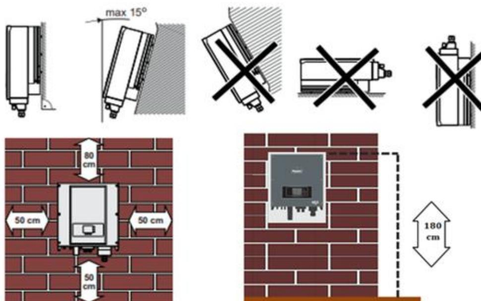
Figura 8 - Requisiti di installazione per un singolo inverter
