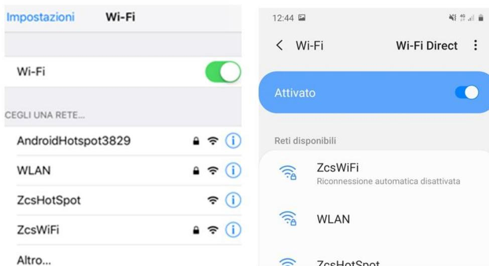
Figura 52 - Ricerca delle reti wifi su Smartphone (iOs e Android); l'Access Point della scheda wifi non è più visibile
