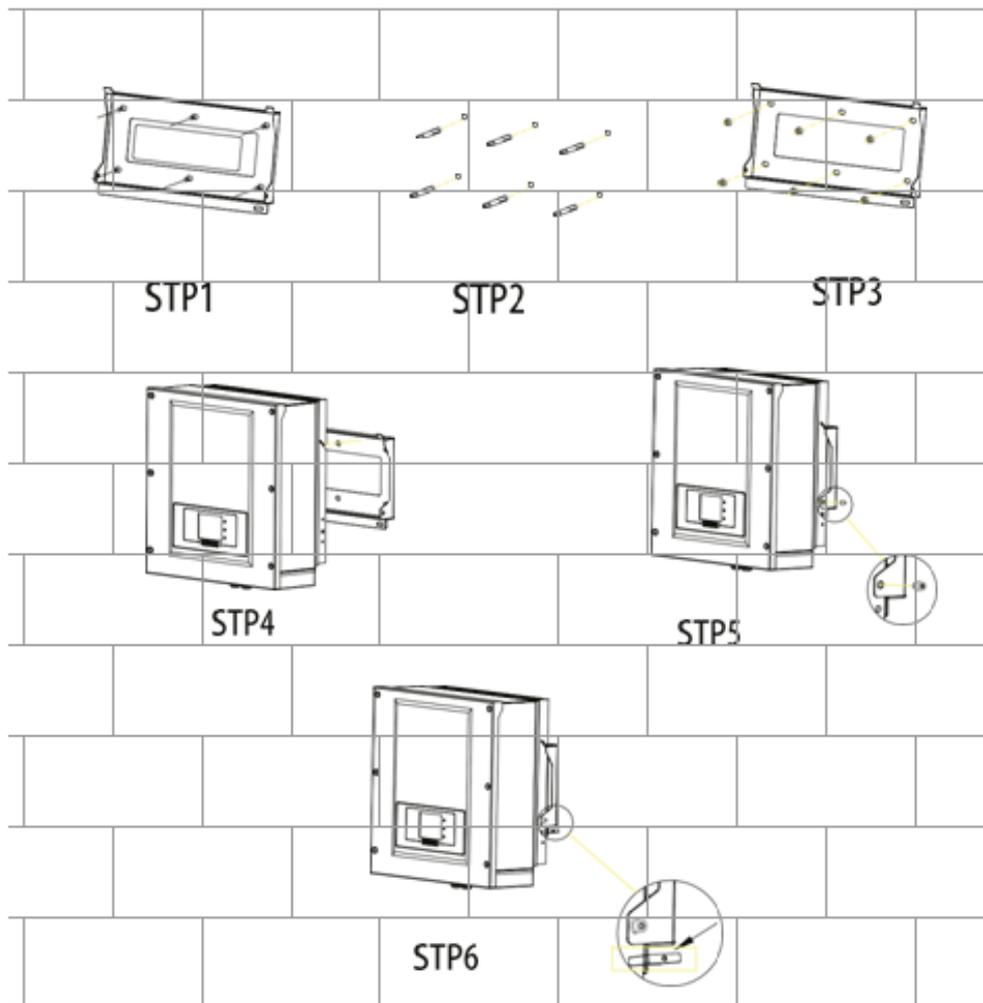
Figura 10 - Passaggi per l'installazione a parete dell'inverter
