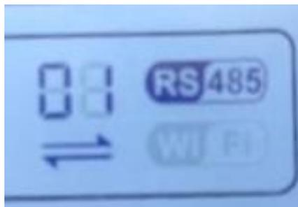
Figura 83 – Simbolo RS485 sul display dell’inverter
