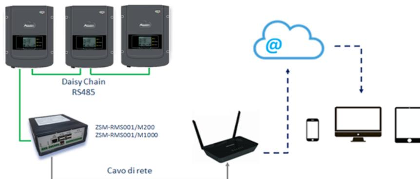
Figura 77 - Schema di funzionamento del datalogger ZSM-RMS001/M200 / ZSM-RMS001/M1000
