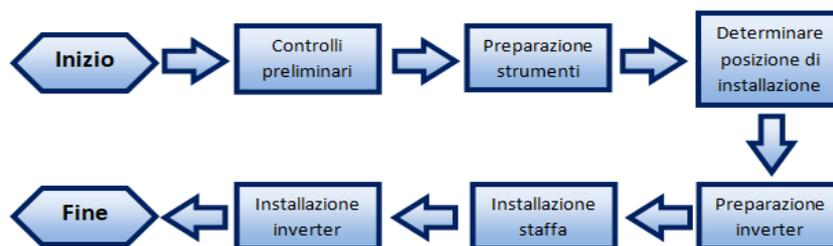
Figura 7 - Passaggi di installazione
