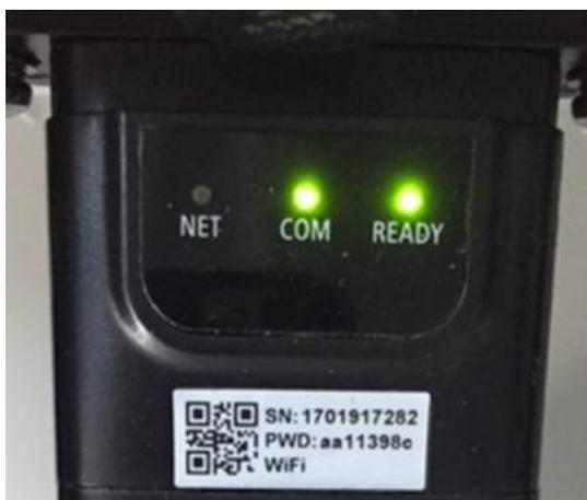
Figura 69 – Stato di comunicazione irregolare tra scheda e server remoto
