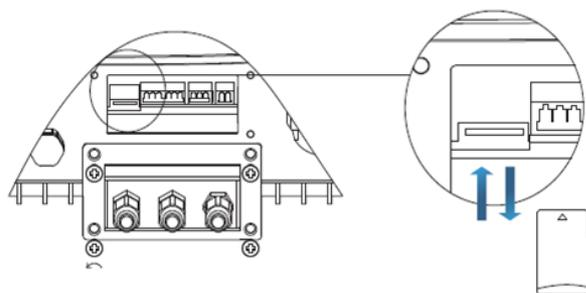
Figura 36 - Posizione ed estrazione della scheda micro SD
