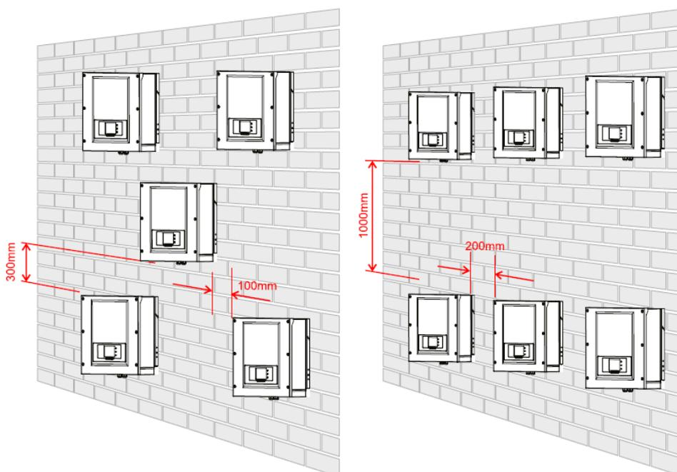
Figura 9- Requisiti di installazione per più inverter
