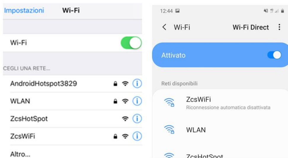
Figura 53 - Ricerca delle reti wifi su Smartphone (iOS e Android); l'Access Point della scheda wifi non è più visibile
