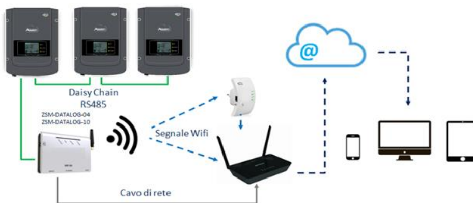
Figura 77 – Schema di connessione del datalogger ZSM-DATALOG-04 / ZSM-DATALOG-10
