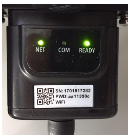
Figura 58 - Stato di comunicazione irregolare tra inverter e wifi
