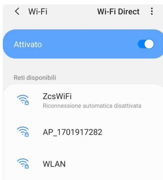
Figura 41 – Disattivazione della riconnessione automatica ad una rete
