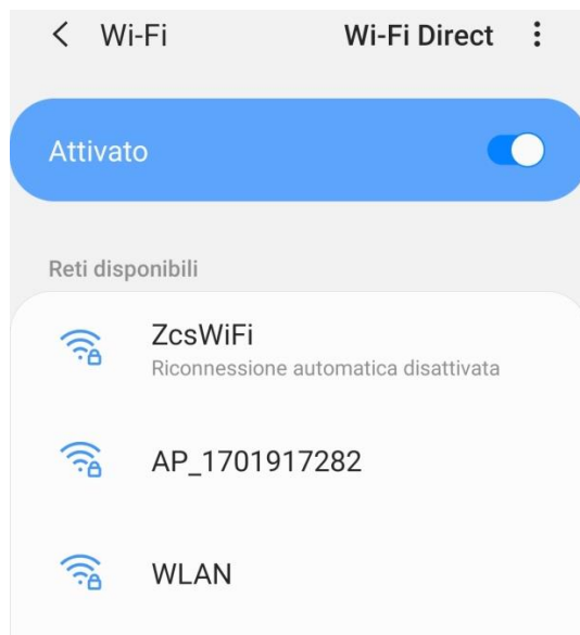
Figura 87 - Disattivazione della riconnessione automatica ad una rete
