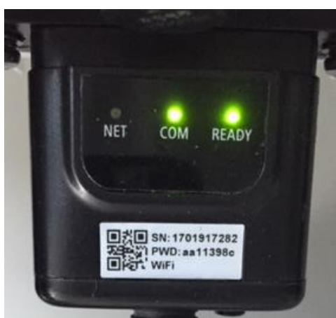
Figura 60 – Stato di comunicazione irregolare tra wifi e server remoto
