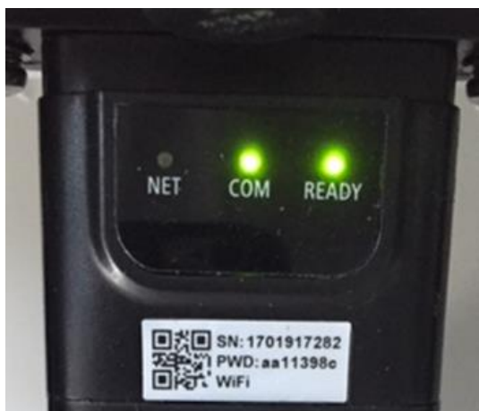
Figura 70 – Stato di comunicazione irregolare tra scheda e server remoto
