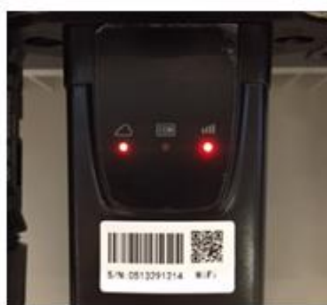
Figura 58 - Stato di comunicazione irregolare tra inverter e wifi
