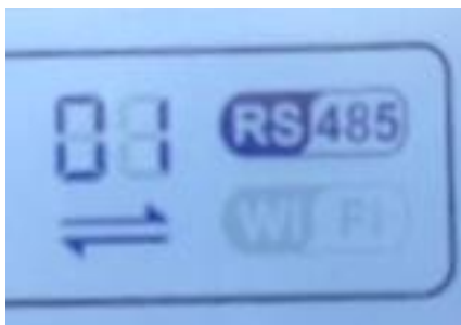
Figura 84 – Simbolo RS485 sul display dell'inverter
