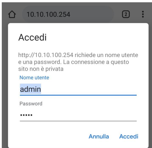
Figura 90 - Schermata di accesso al web server per la configurazione del datalogger
