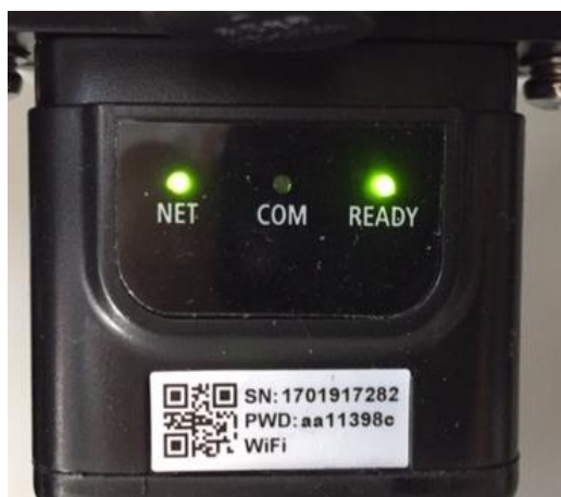
Figura 69 - Stato di comunicazione irregolare tra inverter e scheda
