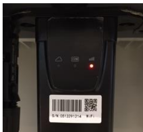
Figura 60 – Stato di comunicazione irregolare tra wifi e server remoto
