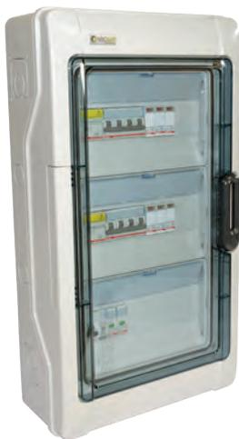
**Quadri UnicoBox**, composti da interruttori magnetotermici differenziali, potere di interruzione da 6 kA, 300 mA di classe A per la protezione di ogni inverter, scaricatore di sovratensione trifase 20 kA con relativa protezione.
