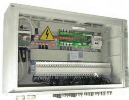
**Quadri di campo con supervisione**, composti da portafusibili 2P con fusibili con tensione nominale di esercizio pari a 1000 VDC, interruttori sezionatori sottocarico con tensione nominale da 600/800/1000 VDC, centraline controllo stringhe modbus RS485, scaricatori di sovratensione di Classe II con corrente di scarica massima I<sub>max</sub> 40 kA.
