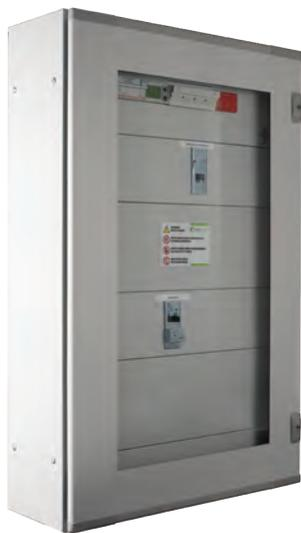
**Quadri di interfaccia**, composti da: interruttori sezionatori tetrapolari. Scaricatore di sovratensione trifase 20 kA con relativa protezione; Relè di interfaccia conforme alla norma CEI 021 e CEI 0-16.
