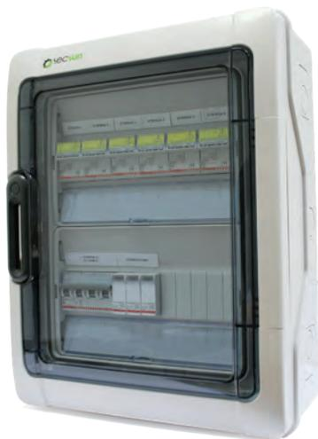
**Quadri di campo**, composti da portafusibili 2P con fusibili con tensione nominale di esercizio pari a 1000 VDC, interruttori sezionatori sottocarico con tensione nominale da 600/800/1000 VDC, scaricatori di sovratensione di Classe II con corrente di scarica massima  $I_{max}$  40 kA.
