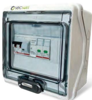
**Quadri AC**, (senza interfaccia), composti da interruttori magnetotermici differenziali, potere di interruzione da 6 kA, 300 mA di classe A per la protezione di ogni inverter, scaricatori di sovratensione trifase 20 kA con relativa protezione.
